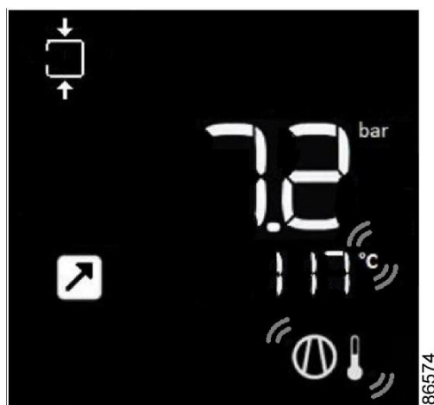
Huvudskärmen med utloppstemperatur nedstängning
