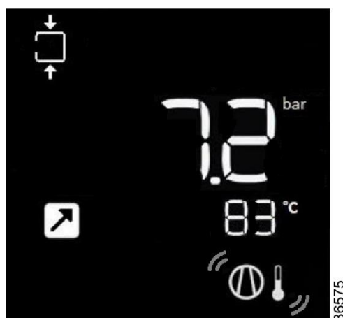
Huvudskärmen med temperaturbrytare nedstängning
