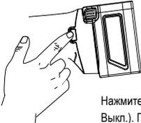
Нажмите кнопку On/Off (Вкл./Выкл.). При этом включается ЖК-дисплей и подаётся один звуковой сигнал.
