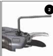
Capovolgere l'utensile e svitare la vite di fissaggio del bullone centrale.
