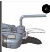
Die mittlere Schraube lösen.
