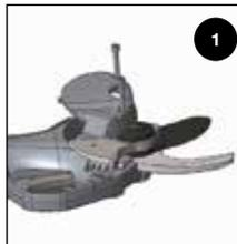
Снимите крышку системы привода ножей.
