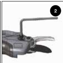
Volte a ferramenta ao contrário e desaparafuse o parafuso de bloqueio central.
