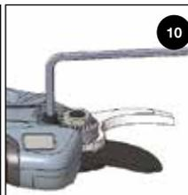
Die mittlere Schraubverbindung festziehen.
