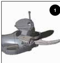
Zdejmij osłonę układu napędzającego ostrze.
