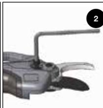
Retourner l'outil et dévisser le dispositif de verrouillage du boulon central.
