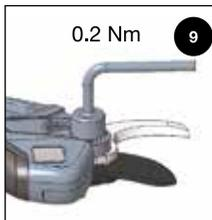
Trekk til den midtre mutteren (0,2 Nm).
