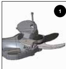
Retire la tapa del sistema de accionamiento de la hoja.
