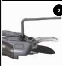
Draai het gereedschap om en schroef de centrale boutvergrendeling los.
