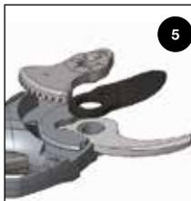
Wymij i oddziel układ napędzający od ostrza.
