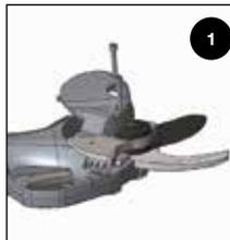
Αφαιρέστε το κάλυμμα του συστήματος κίνησης λεπίδας.
