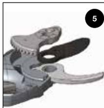
Снимите и отсоедините систему привода и нож.
