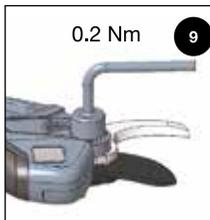
Serrer l'écrou central (0,2 Nm).
