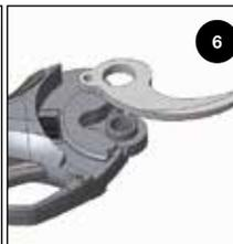
Rimuovere la controlama se è necessario sostituirla.
