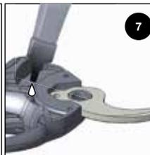
Очистите и смажьте консистентной смазкой все детали, включая шестерню.
