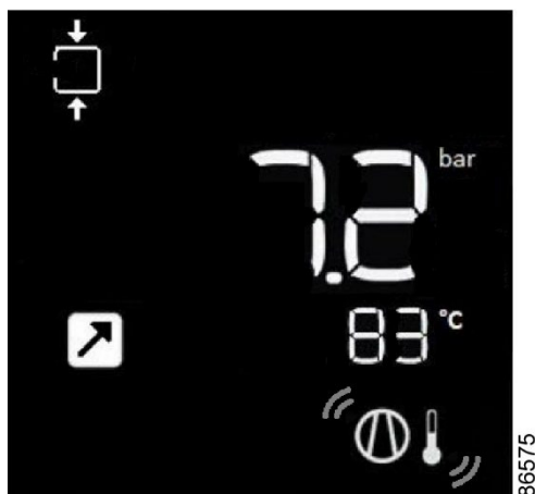
Huvudskärmen med temperaturbrytare nedstängning
