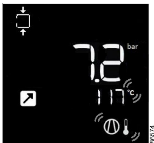
Huvudskärmen med utloppstemperatur nedstängning
