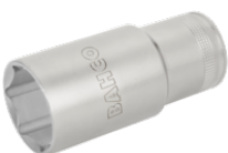
Sexkantshylsa lång, med 1/2" fyrkantfäste, 14 mm 7805SM-14
