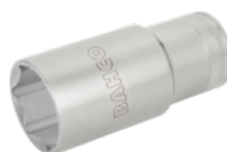
Sexkantshylsa lång, med 1/2" fyrkantfäste, 13 mm 7805SM-13
