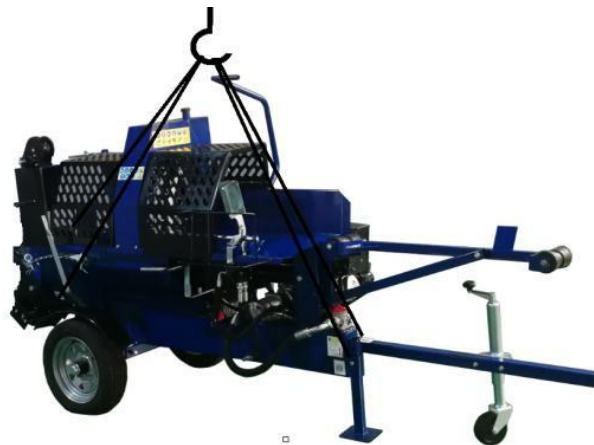
Fig. 4-3 Transportskiss med kran (efter uppäckning)
